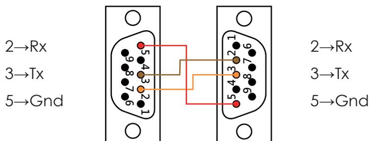
控制系統採用RS232控制是非常普遍、好用，整體介面優於IR紅外線發碼，IR易受於燈光干擾、遮蔽所影響。RS232可透過軟體碼的結合，變成RS485/RS422等控制協定，可用於攝影機的控制，線路可採用並聯的方式，一次控制多支攝影機的功能。另外，現市售的機器設備中，較多已內建RS232控制功能，如投影機、矩陣、擴大器、混音器等，所以控制方法為RS232協定是較好的選擇。
