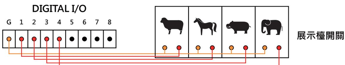
以上幾個應用方式，其透過感知器警報的方式來觸發I/O接點，並透過程式對應，執行所需發報功能，如一氧化碳、瓦斯濃度過高時，自動開啟門窗，使空氣流通；或透過展示臺按鍵開關，來執行語音、燈光、節目行程等。
